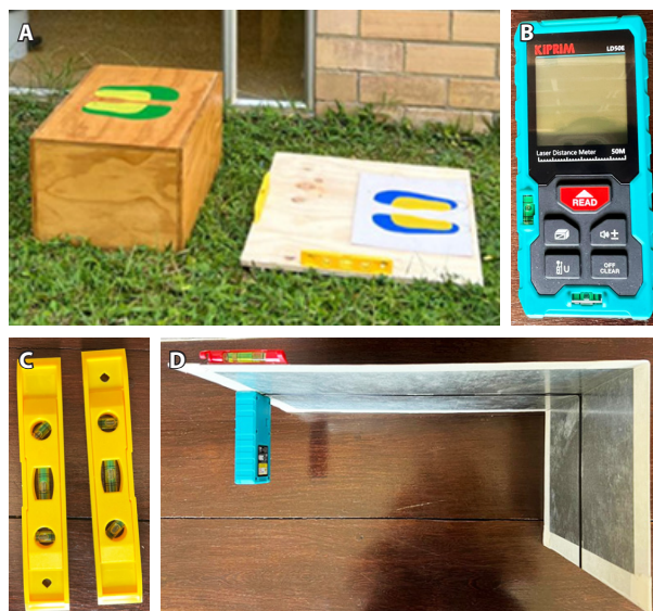
Figura 2. Medidor láser y los elementos que se usaron para la obtención de la talla. A. Tabla para pararse en campo abierto. B. Medidor láser (Kiprim LD50E). C. Niveles para medidor. D. Pieza diseñada en aluminio para el uso del medidor láser. Elaboración propia.
